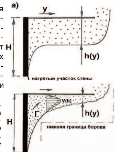
Рис.174. Поток горячего газа на потолке: а - математическая гидравлическая модель Есьмана [60] течения горячего невязкого газа, б - уозрительная гидравлическая модель течения горячего вязкого газа, ламинарно набегающего на потолок.  $V(h)$  - изменение линейной скорости по толщине слоя,  $h(y)$  - изменение толщины слоя по тракту.
