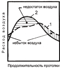
Рис.273. Диаграмма Кирша: 1 - расход воздуха, обеспечиваемый тягой дымовой трубы, 2 - расход воздуха, потребный на горение дров в топке [117, 118].
