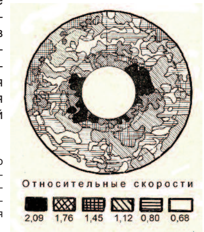
Рис.264. Распределение скоростей воздуха по сечению модельного проточного цилиндрического аппарата, заполненного шарообразными зернами. Диаметр аппарата 185 мм, диаметр внутренней центральной трубки 62 мм, высота слоя зерен 135 мм, диаметр зерен 5,9 мм [121].
