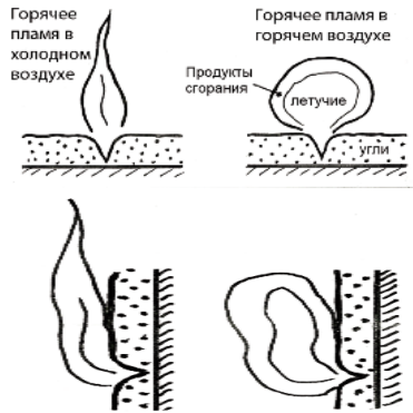
Рис.267. В горячих газах микротопок между поленьями горячие газы пламен всплывают медленнее /или вообще не всплывают/.
