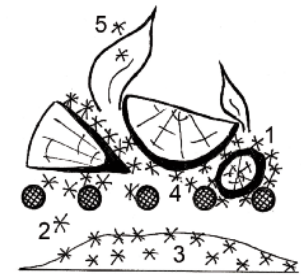
Рис.295. Пепел /изображенный "звездочками"/ образуется при горении древесных углей, накапливается на поверхности углей или на поверхности обугленной древесины 1, проваливается 2 через решетку в поддувало /или на глухой под/, накапливается 4 на решетке /или на глухом поде/ или уносится потоком дымовых газов 5.
