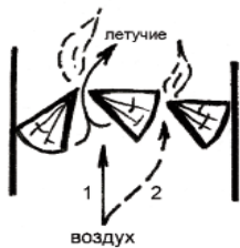
Рис.287. Модель неустойчивости пламени в закладке горящих дров - поток воздуха по траектории 1 вызывает повышенное выделение летучих в зазоре, в результате чего поток воздуха "отталкивается" и устремляется по траектории 2.
