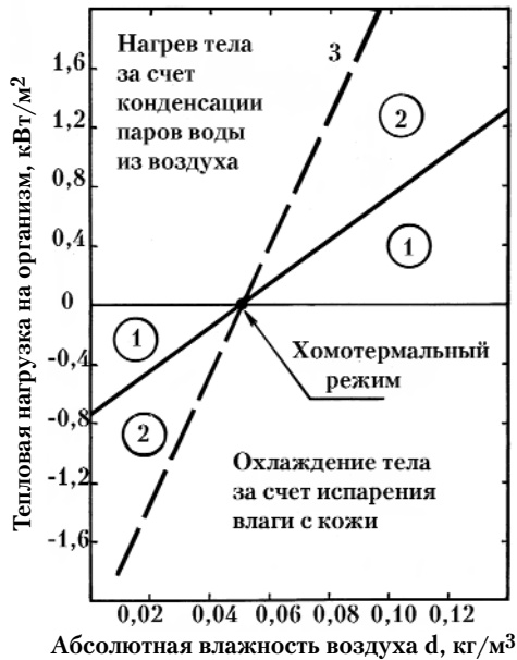
Рис. 46. Тепловой поток на тело человека (при произвольной температуре), обусловленный испарением влаги с мокрой кожи человека (поток отрицательный, поскольку тело человека при этом охлаждается) или конденсацией паров воды из воздуха на мокрую или сухую кожу человека (поток положительный). Зона 1 – вклад охлаждения (нагрева) за счёт испарения (конденсации) в неподвижном воздухе (кондуктивная составляющая). Зона 2 – вклад охлаждения (нагрева) за счёт испарения (конденсации) в подвижном воздухе (конвективная составляющая для скорости движения воздуха 1 м/сек). Кривая 3 – суммарный тепловой поток (сумма кондуктивной и конвективной составляющих при скорости воздуха V=1 м/сек).
