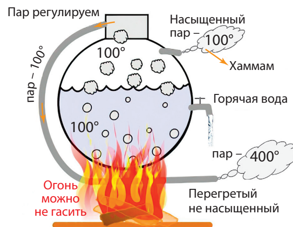
Рис. 9. Эффективный Бойлер+ даёт горячую воду, пар 100°C и пар 400°C
