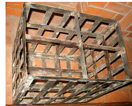
Рис.2. Бункер для каменки по-белому – камни калим через стенку корыта (слева), сетка для камней по-чёрному , помещаемая в огонь печи (справа).
