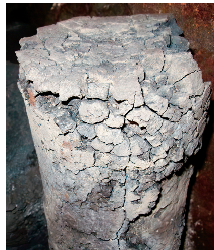
Рис. 7. Вот во что превращается монолитный чугун после пребывания в печи в качестве теплоаккумулятора и парогенератора
