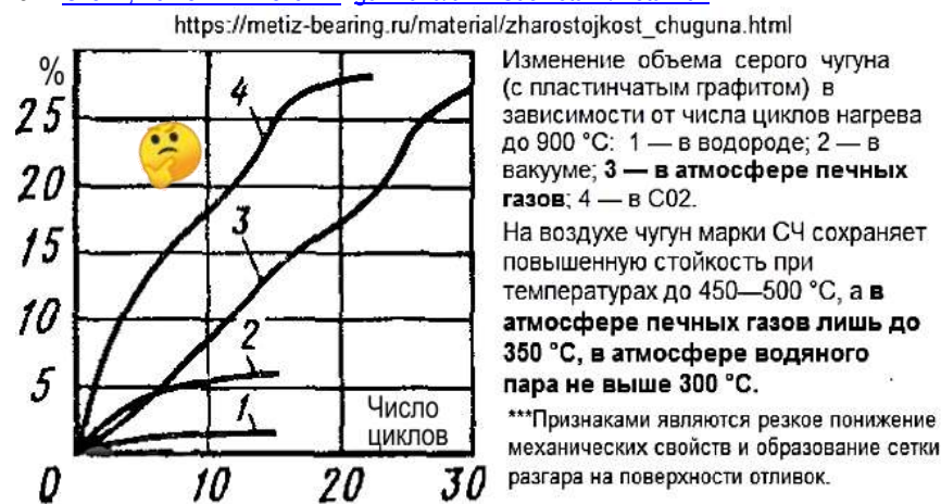
Рис.3. Набухание чугуна при нагреве, в атмосфере печных газов (кривые 3,4)
