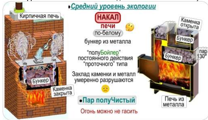
Рис. Э-3. Накал-печи по-белому, заклад каменки в бункере из металла, т.е. косвенный нагрев через стенку бункера - по-белому..
