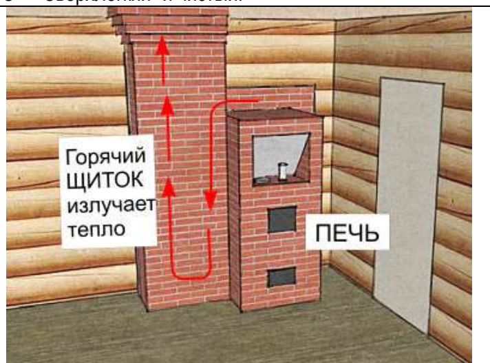
Рис. 3. Кирпичная облицовка печи более горячая, чем щиток и поэтому щиток надо располагать ближе к полкам. От щитка идёт мягкое тепло, приятное человеку, который сидит или лежит около него.
