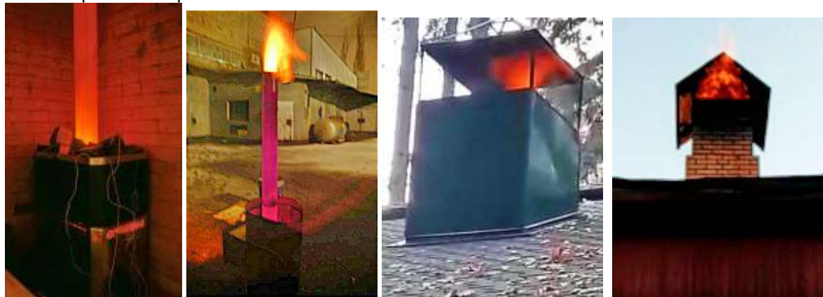
Рис. 1 После металлической печи дым.газы догорают ещё 3-5 м.
