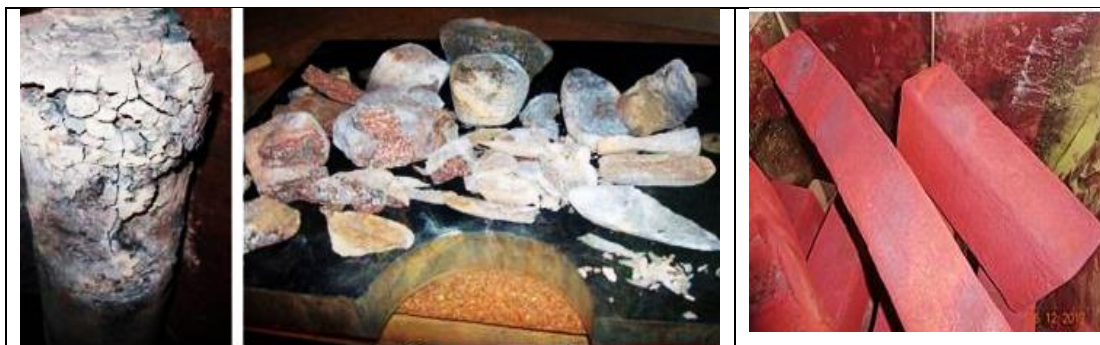
Рис. 1-1. Разрушение в навал-каменке серого чугуна, камней и хромистого чугуна (красный).
